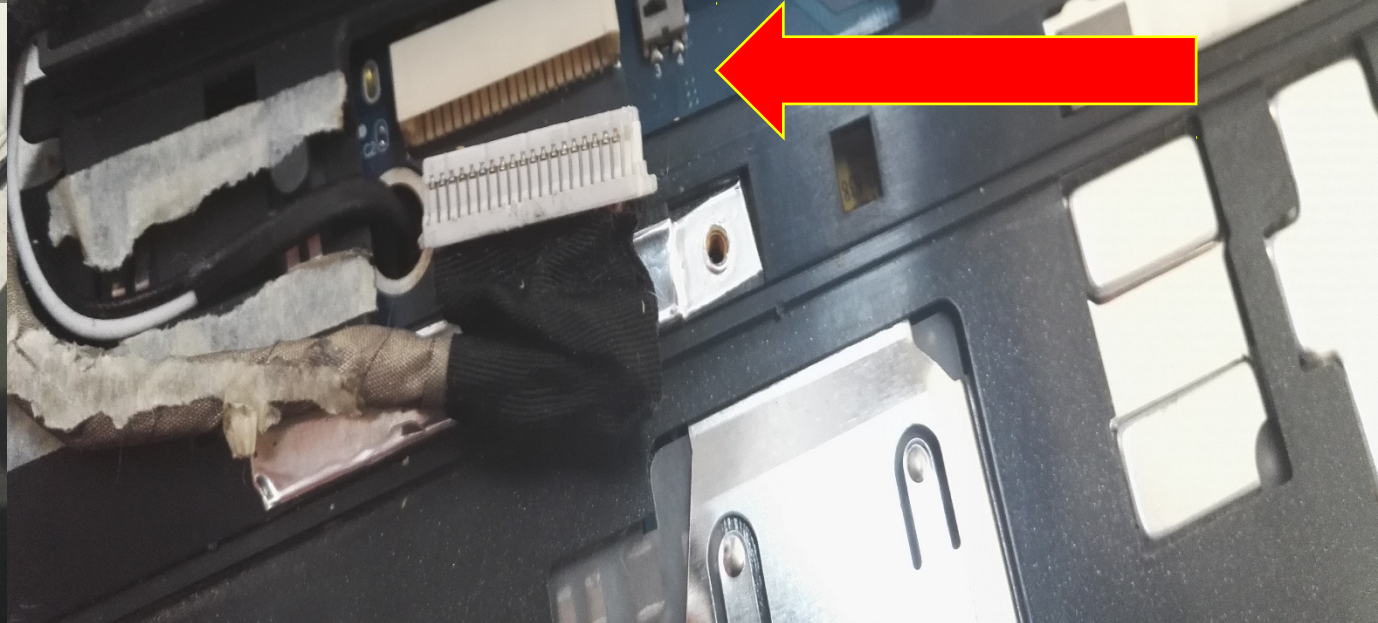
13. Podłączamy kabel łączący wyświetlacz z płytą główną oraz małe kabelki zasilania.
