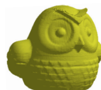
Wynik skanywania obiektu pokrytego gumową powłoką w aerozolu
