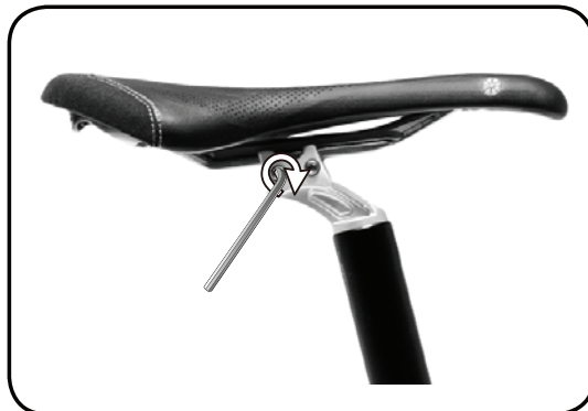
Krok 5 - Dokręć wcześniej nasmarowane preparatem Loctite 222 lub 242 śruby jarzma sztycy momentem obrotowym 85 in/lbs lub 9,5 NM.
