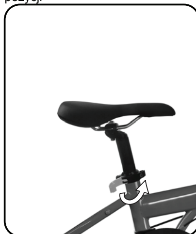
Krok 3 Dokładnie zamknij zacisk quick release
