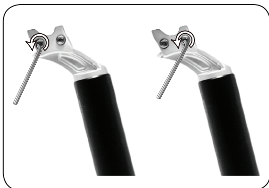
Krok 1 - Poluzuj śrubę jarzma sztycy Kore I-Beam za pomocą klucza imbusowego 4 mm.
