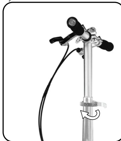
Krok 3 Dokładnie zamknij zacisk quick release
